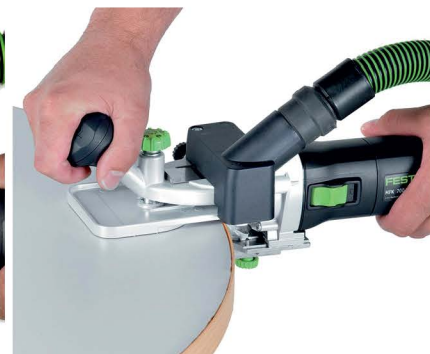
Výkonné riešenie frézovania hrán. Dokonalé vedenie frézy zabezpečuje dokonalé opracovanú hranu dielca.
