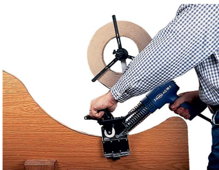
Teplovzdušná olepovačka pre pásy s naneseným lepidlom.
