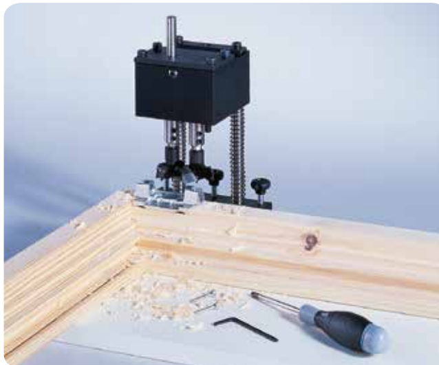
Fissaggio della cerniera superiore/ Fixing of top hinge
