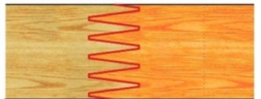
Ozubený profil je frézovaný v celej výške materiálu. Využíva sa na konštrukčné prvky v stavebnom stolárstve, ako napr. KVH hranoly.
