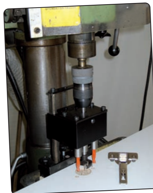
Art TRIMATIC 48/9 per cerniera tipo "Mepla" hinges type "Mepla"
