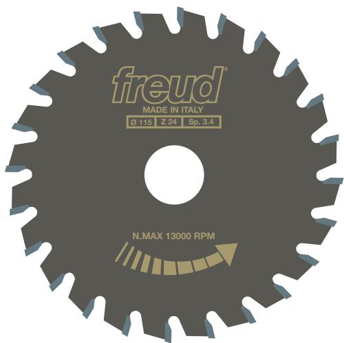
> Lame utilizzate in complemento delle lame per la sezionatura di pannelli rivestiti da ambo le parti, per eliminare le scheggiature nella parte inferiore del materiale lavorato. L'addentramento nel taglio è in funzione dello spessore della lama di taglio. Utilizzabile su macchine con regolazione dell'albero in altezza.
