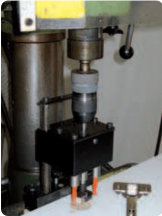
TRIMATIC 48/6 DRILLING UNIT FOR HINGES/ TRIMATIC 48/6 Bohrmaschine für Scharniere
